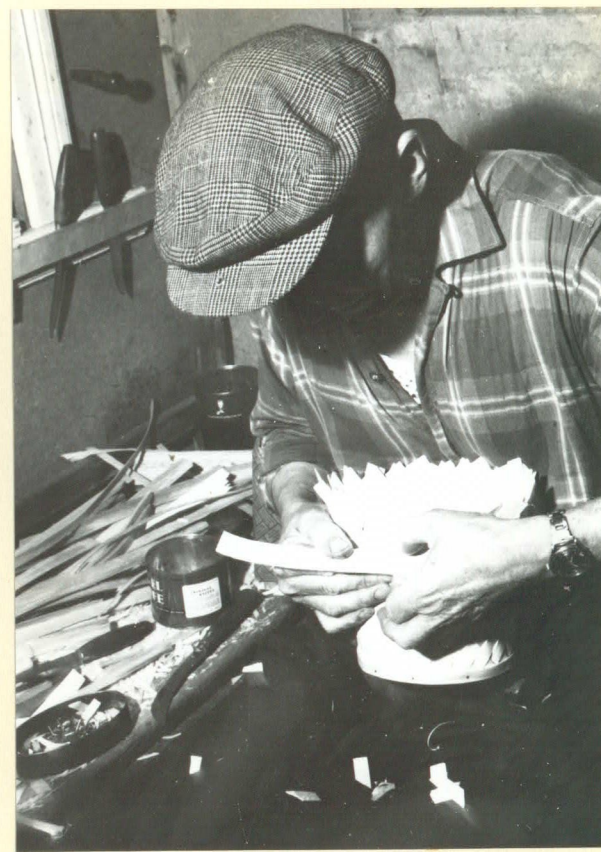
Yttergajden kring korgens övre kant läggs på.
