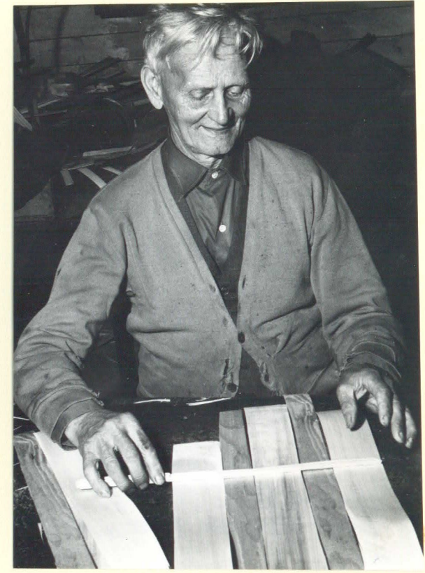
Uppläggning till bänkorg.
